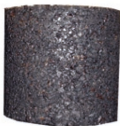
Лабораторный образец RAP с применением комплексного вяжущего
